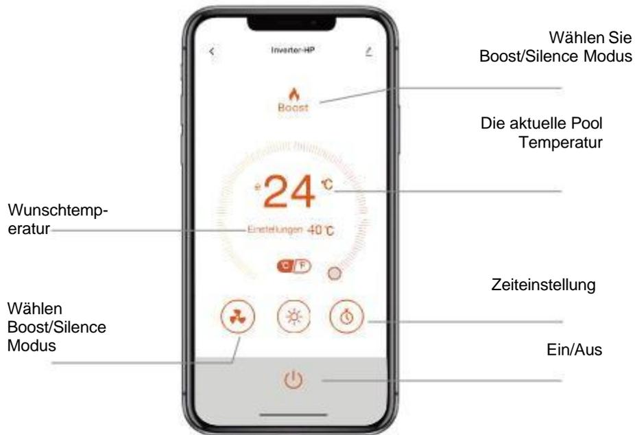
2. Für Wärmepumpe mit Heiz- und Kühlfunktion:
